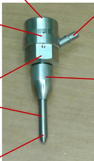
Il tubetto di adduzione abrasivo è inclinato di 40°, il che agevola ed incrementa la velocità delle particelle di abrasivo all'interno della camera di miscelazione. Il pezzo è smontabile e sostituibile una volta usurato.
